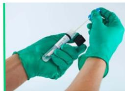
Feuchter Tupfer im Testpuffer im N-Light™ ATP-Teströhrchen
