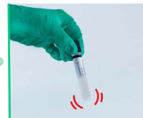
10 s ( $\pm$  1 s) lang schütteln, bis die Reagenztablette vollständig aufgelöst ist
