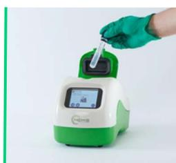
Das Reagenzglas in das Luminometer stellen
