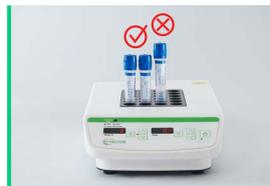
Insérer complètement les tubes à essai dans le Dry Block Heater.
