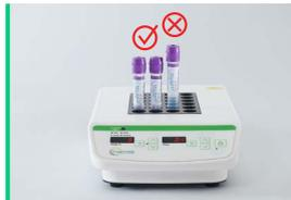
Setzen Sie die Proberöhrchen vollständig in die Vertiefungen des Trockenblockheizers ein
