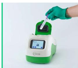
Das Reagenzglas in das Luminometer stellen
