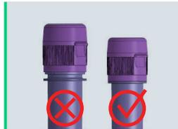
Stellen Sie sicher, dass jedes Proberöhrchen vollständig verschlossen ist
